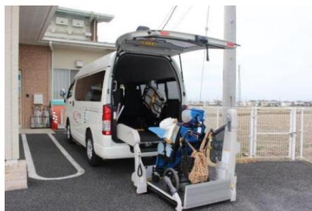
図 43 車椅子用リフト付福祉車両利用時のイメージ
