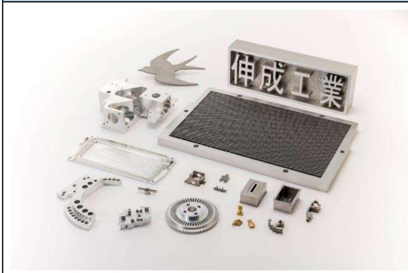
金属精密フライス加工で、主に産業向けの機械などの試作、量産部品を製作しています。主要分野は半導体、コンデンサー関係から、測定機、医療系、食品関係などの分野の部品製作を手掛けています。マシニング加工+ワイヤー加工+研削加工での複合加工製作を、特徴としていまして、加工可能な大きさは、およそ400x800mm、質量は20KG位までの製作が可能です。一般鋼材、ステンレスなど、特にアルミ材の加工を得意としています。
