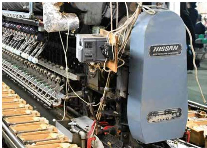
半世紀近く前に作られた日産自動車製自動繰糸機。[自動で生糸を挽くのは人類に不可能]と言われながらも、日本が世界に先駆けて完成させ、大量の生糸生産を可能にした。後に輸出され、世界のシルク産業を支えた。同型が富岡製糸場繰糸場にあるが停止状態で展示中。碓氷製糸では整備をしながら、今も現役で稼働している。
