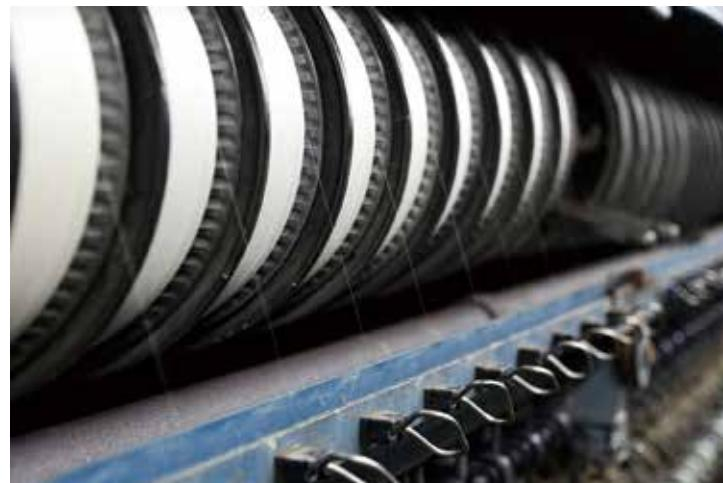
煮た繭から糸を出し、目的の太さの生糸になるよう繭糸をより合わせる「縄糸」。繭糸1本の太さは、髪の毛の約4分の1といわれる。
