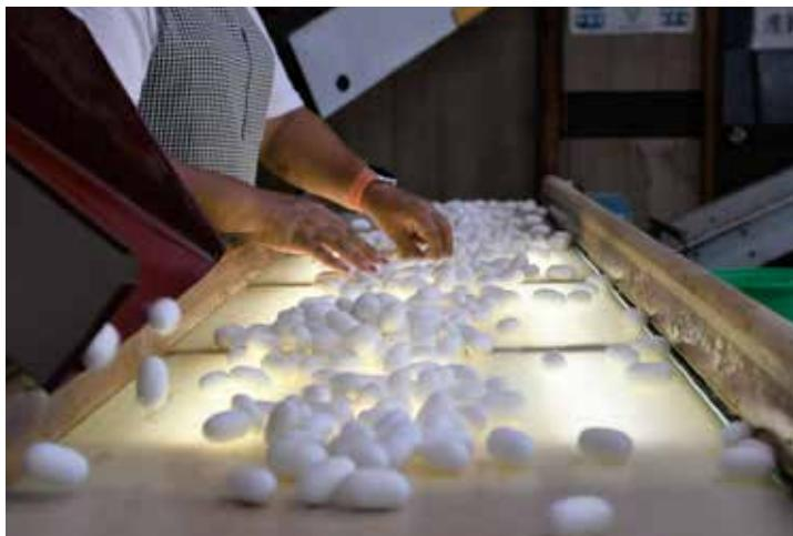
ベルトコンベヤーを流れる、乾燥させた繭から規格外のものを除く「選繭」。中の汚れを見やすくするため、下から光を当てる。
