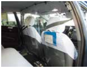
※安中市タクシー事業者支援助成金を活用し対策を行っております(客席と乗務員席の間に仕切りを設置し、飛沫の飛散防止に取り組む)。
