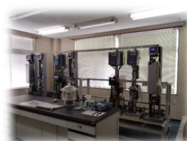
水質発信器（連続測定用水質計器）
